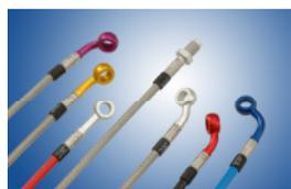
Der Vorteil der Stahlflexbremsleitungen liegt bei einem exakten Druckpunkt, bester Dosierbarkeit, weniger Hebelkraft, und der Sicherheitsgarantie, dass jeder Schlauch auf 250 bar geprüft und anschliessend gereinigt wurde.
