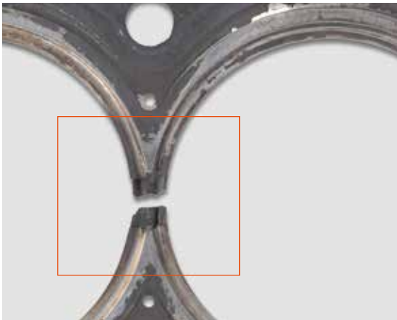
▲ Gebrochener Steg verursacht durch hohe Bauteildynamik
