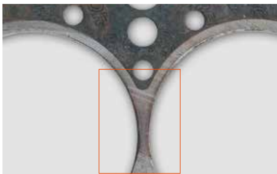
▲ Raue Oberflächen von Motorblock und Zylinderkopf führen zum Gasübertritt zwischen den Brennräumen.
