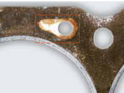
▲ Aufquellungen bei Weichstoff-Zylinderkopfdichtungen durch Überhitzung mit Dampfbildung.
