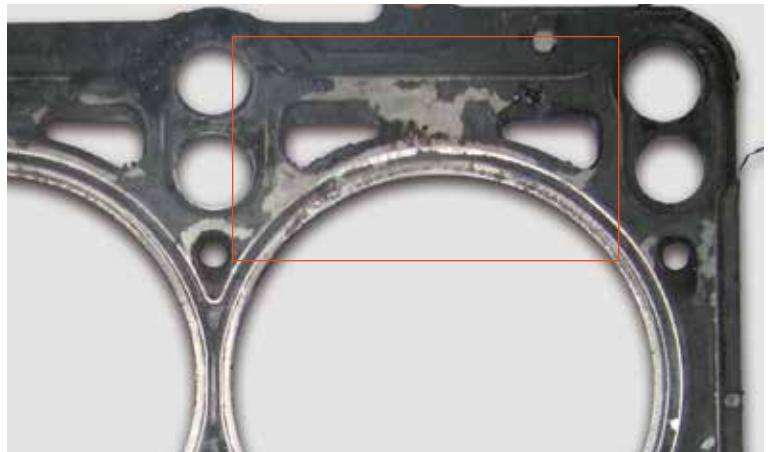
▲ Durch Überhitzung beschädigte Elastomerbeschichtung
