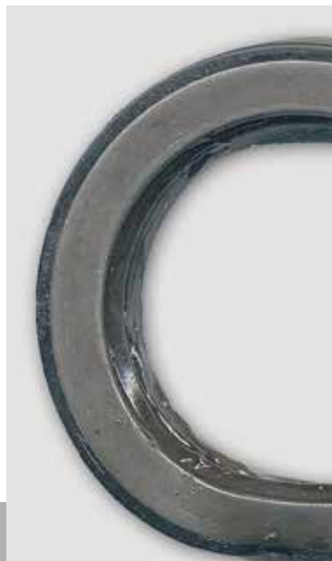
▲ Gefettete PTFE-Dichtlippe als Ausfallursache.
