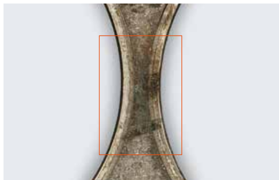
▲ Gasleckage mit lokaler Schwarzfärbung der Brennraumeinfassung.
