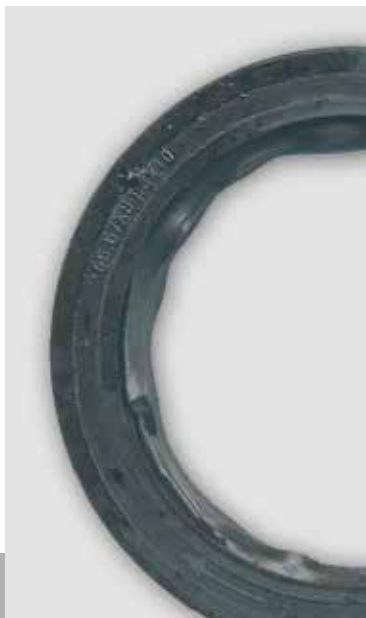
▲ Beschädigte PTFE-Dichtlippe als Ausfallursache.
