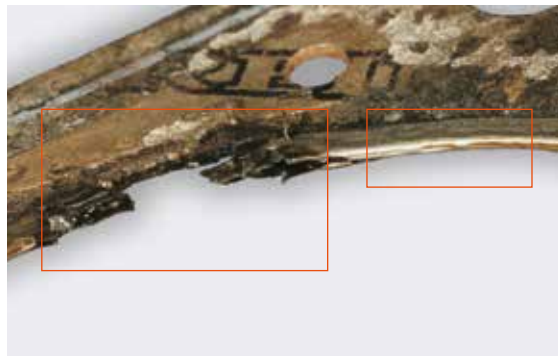
▲ Eindellungen und Verquetschungen mit und ohne Überblasen durch Klingelbetrieb.
