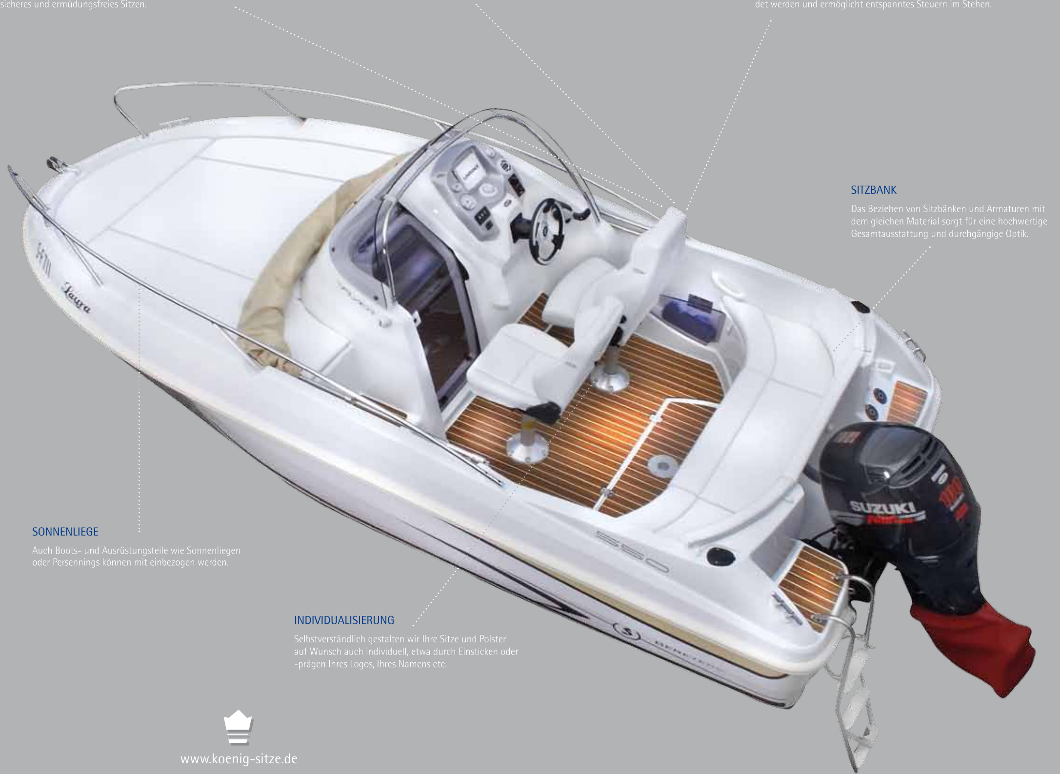
DREHEN Mithilfe eines drehbaren Sockels lässt sich der Sitz um 180° nach hinten drehen.
